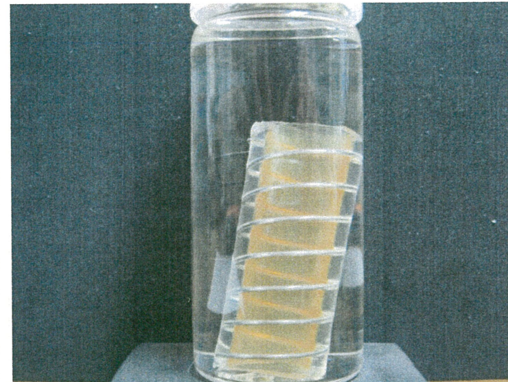
無雑無し5日間循環試験40L/min(左:試験部アクリル配管、右:ホース)
